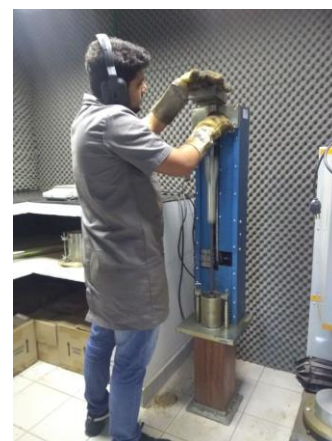
Compactação dos cp's.
