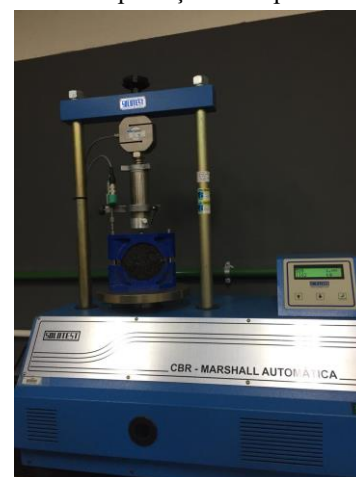
Disposição do equipamento para determinação da estabilidade do concreto asfáltico.
