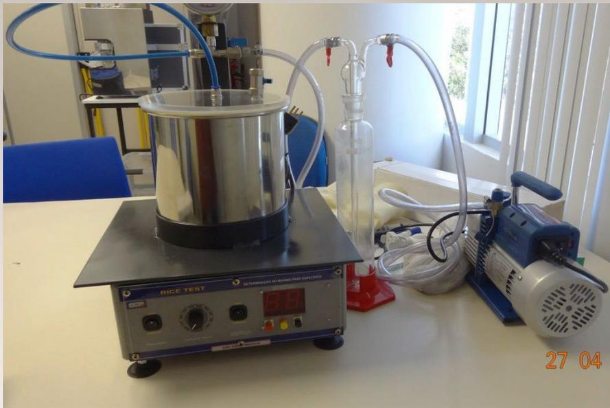
O conjunto de Rice Test permite a determinação da máxima densidade em misturas betuminosas sob condições específicas de vácuo.
